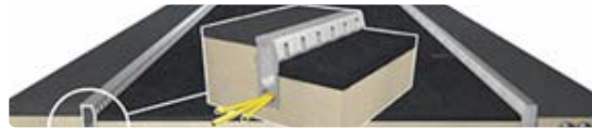
Figure 21. Chemin de câble en béton entre la route et le trottoir. (Source: UGent)
