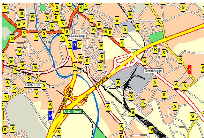
Figuur 5: Illustratie van het uitzetten van de knooppunten van het te modelleren netwerk (X = LEX; D = LDC; S = SC)
